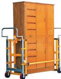
Přepravovaný kus nábytku nesmí být ponechán na tomto zařízení bez dozoru. Je třeba jej vždy spustit na podlahu.
