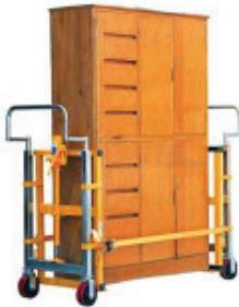
Skåpet som transporteras får inte lämnas utan övervakning på utrustningen. Det måste alltid sänkas ned till golvet.
