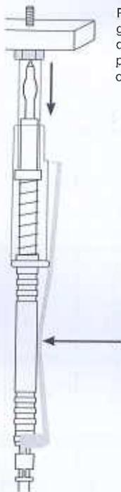
Pour effectuer un test, appuyez sur la gâchette. Cela déverrouille la protection de la pointe qui peut coulisser. Vous pouvez ensuite l'introduire dans une prise ou l'amener au contact de l'objet à tester.
