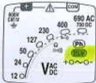
Dans le cas d'une tension à proximité de l'élément testé, l'appareil peut indiquer la présence d'une tension de service sur l'élément testé.
